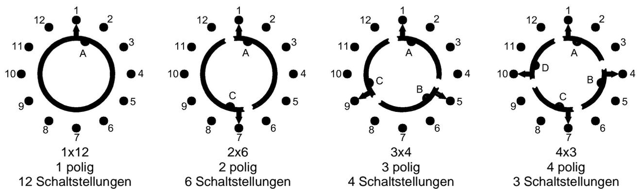
**Stellung der Achsanflachung bei Linksanschlag des Schalters:**
